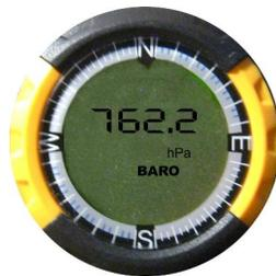
Por ejemplo: El valor de la medida de la presión de aire actual es 1013.2hPa, y el valor de la presión de aire real es 1013.1hPa, entonces la compensación de la calibración puede ser obtenida del reporte del clima, con barómetro de certificado de alta exactitud, y así sucesivamente. Esta operación puede avanzar la exactitud del sensor de la presión.
