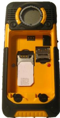
**Quitar:** Asegúrese de que el teléfono esté apagado. Quite la batería; Presione la barra de plástico hacia abajo y con la otra mano empuje la tarjeta SIM hacia afuera. Por ultimo inserte la batería.
