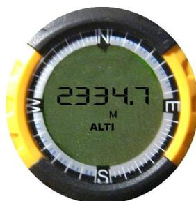
El valor se debe fijar a la presión barométrica absoluta de la altitud de la referencia. Y el valor mostrado en estado normal de ALTI es altitud de la referencia que se refiere a la altitud, que es fijada por el usuario en este estado. Cuando la presión de aire de la altitud de la referencia se fija para ser igual como la presión actual de Baro, después la altitud de la referencia será alrededor 0 metros.
